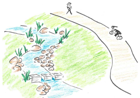
Kuva 8 Mutkittileva avo-oja jossa on virtaamanhidastusta ja eroosiosuojausta. Kuva: Liina Kuittinen 2025
