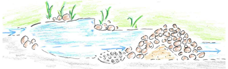
Kuva 7 Laskeutusallas ja suodatuspato. Kuva: Liina Kuittinen 2025
